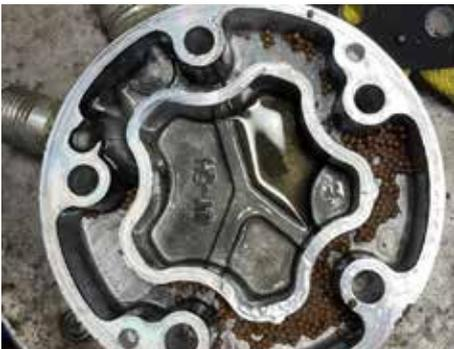
Die Verwendung **von nicht-originalfiltern** kann dazu führen, dass Füllstoffpartikel in das System eindringen, was eine **Blockierung** und **Fehlfunktion** der Systemelemente bis hin zum **Ausfall** des Kompressors zur Folge haben kann
