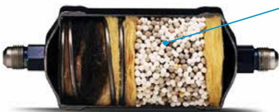
Einige nicht-originaltrockner verwenden einen granularen Füllstoff. Das Füllstoffgranulat reibt bei Vibration oder beim Passieren des Kältemittels aneinander, wodurch die Gefahr besteht, dass feine Partikel in das System gelangen.
