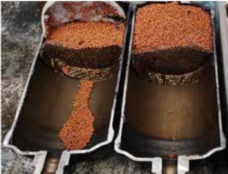
Die füllstoffmenge in einem nicht-original-filter ist **weniger als 1/3 des Filtervolumens**, was seine Ressourcen und Kapazität, Feuchtigkeit und schädliche Verunreinigungen zu entfernen, deutlich reduziert
