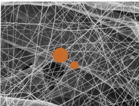
Les cercles oranges représentent les particules avec un diamètre de 2 microns et 5 microns
