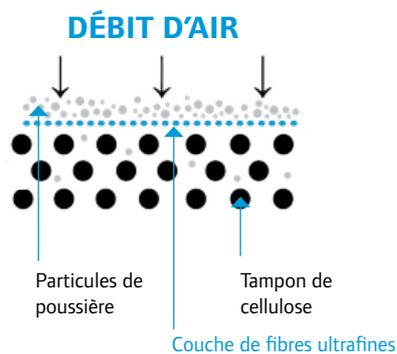
Les filtres Thermo King ont un diamètre de fibre de moins d'un micromètre et de petits espaces entre les fibres. Cela fournit une grande capacité de filtrage (la capacité d'accumuler une grande quantité d'impuretés, ou de fonctionner longtemps sans remplacement) sans augmentation significative de la résistance.
