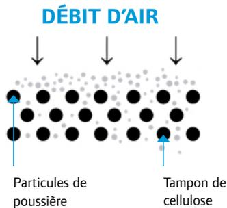
Les fibres de cellulose dans un filtre non authentique présentent de grands écarts entre elles, ce qui permet aux contaminants de pénétrer profondément dans le filtre et de bloquer le débit d'air. Cet effet entraîne une augmentation de la résistance du filtre à mesure que la saleté s'accumule.
