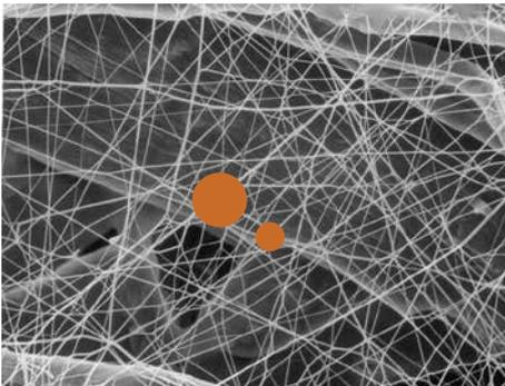
Orangefarbene Kreise stehen für Partikel mit einem Durchmesser zwischen 2 µm und 5 µm
