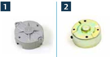
Die Anlasser von Thermo King verwenden eine Endkappe aus Aluminiumguss anstelle der gestanzten, verzinkten Stahlendkappe, die von verschiedenen Wettbewerbern verwendet wird. Aluminium ist korrosionsbeständiger, und der Gussbearbeitungsprozess sorgt für eine stabilere, haltbarere Konstruktion, die für Anwendungen mit hohen Vibrationen wichtig ist.
