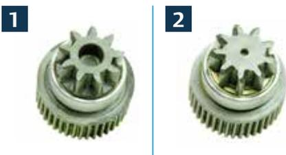
Das Ritzel eines Anlassers wird beim Einrasten in den Zahnkranz des Motors erheblich beansprucht. Stärke und präzise Fertigung der Verzahnung sind entscheidend für die Lebensdauer des Anlassers und Ringzahnads. Anlasser von Thermo King verwenden eine Verstärkungslippe auf dem Ritzel für zusätzliche Verstärkung und nutzen Präzisionsfertigung, um sicherzustellen, dass die Zähne eng in den Zahnkranz eingreifen und so die Lebensdauer erhöhen.
