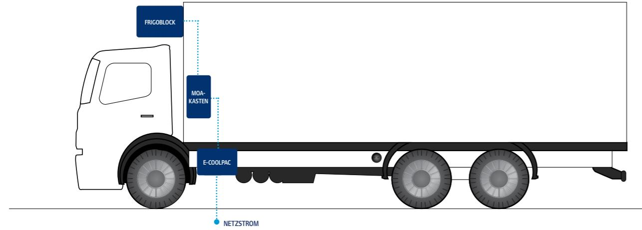
Der E-COOLPAC liefert einen DC-Ausgang (für Frigoblock DC-Maschine) oder einen AC-Ausgang (Frigoblock AC-Maschine).
