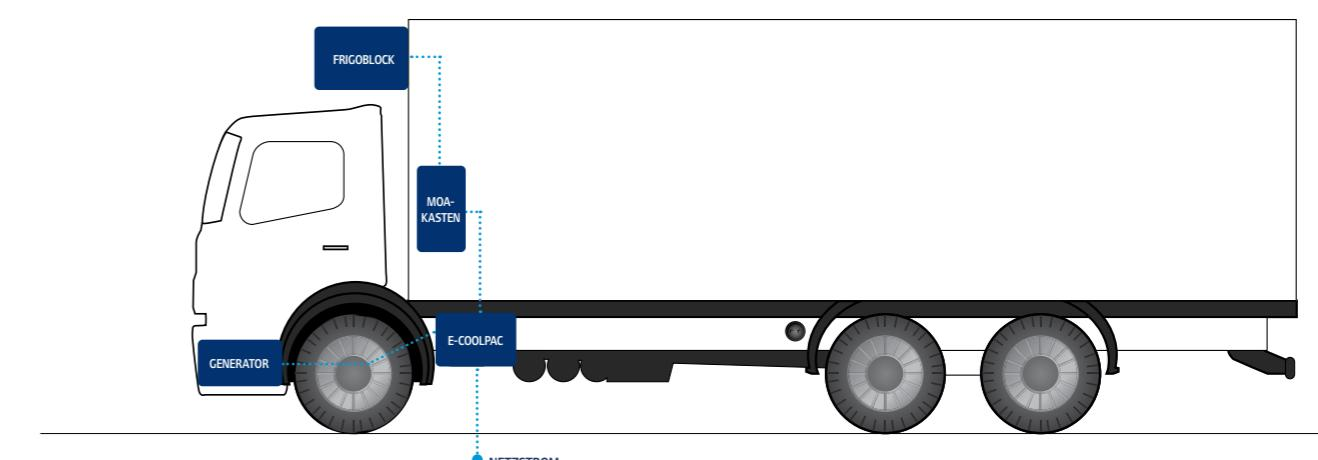
Der E-COOLPAC liefert einen DC-Ausgang (für Frigoblock DC-Maschine) oder einen AC-Ausgang (für Frigoblock AC-Maschine).
