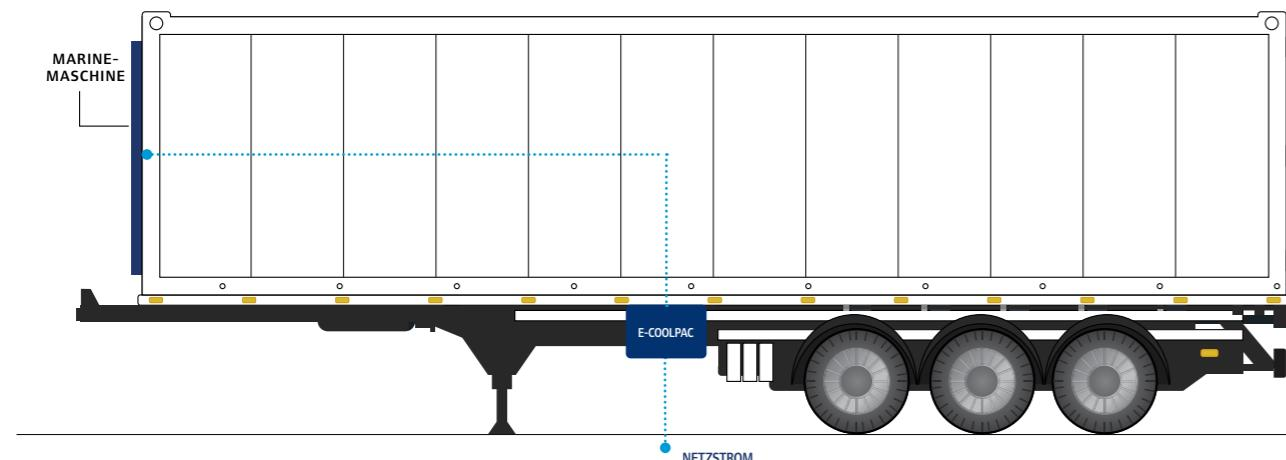
Das E-COOLPAC bietet einen AC-Ausgang und versorgt die Kältemaschine im Standby-Modus mit Strom.
