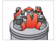
Unter ungewöhnlichen Bedingungen, wie z. B. bei extremem Druck, der entsteht, wenn flüssiges Kältemittel oder Öl in den Zylinder eindringt, öffnen sich alle Hochdruckventilplatten, um den überschüssigen Druck abzulassen. Dieses zweistufige Druckablasssystem verlängert die Gesamtlebensdauer des Kompressors.
