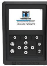
Lorsque la séquence de mise en route du système est terminée, l'affichage standard apparaît, et le groupe frigorifique démarre en mode thermique (si aucune alimentation électrique n'est détectée).
