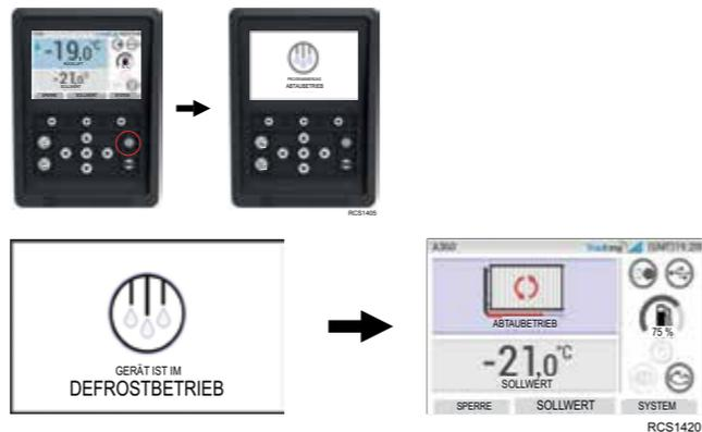
Nach Abschluss des Abtaubetriebs wird auf der HMI 2 Sekunden lang „BEENDEN DEFROST“ angezeigt und dann zur Standardanzeige zurückgekehrt.
