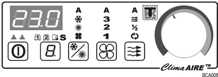
EIN/AUS (1) ANZEIGE (2) MODUS (3) DREHZAHL (4) LÜFTUNGSBETRIEB (5) THERMOSTAT (6)
