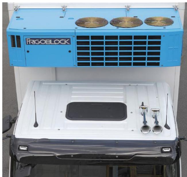
Des connexions électriques à fiches et des raccords rapides pour le fluide frigorigène, l'eau glycolée et le carburant permettent un remplacement du groupe FRIGOBLOCK en quelques minutes. Cela permet une réparation de qualité durant les horaires de travail normales et améliore les durées d'utilisation du véhicule.
