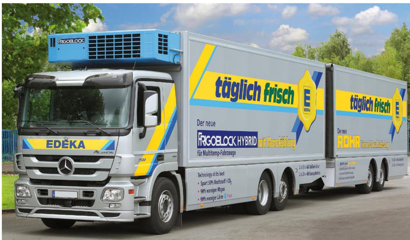
Ensemble articulé tandem de 20 m avec 2 x 20 = 40 palettes Euro. Le timon hydraulique permet un déchargement à l'abri sans déperditions. L'alimentation de la remorque en énergie frigorifique est assurée pour la première fois par un circuit supplémentaire eau glycolée pour applications positives, sans qu'un groupe frigorifique supplémentaire sous plancher soit nécessaire.
