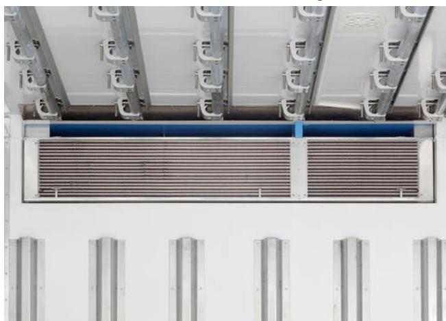
Trois évaporateurs surdimensionnés au maximum sont montés à l'abri dans le châssis du groupe FRIGOBLOCK. Cela sur toute la largeur de la carrosserie et à l'extérieur du compartiment de chargement. Le système hydraulique de basculement FRIGOBLOCK permet d'économiser env. 300 mm de hauteur de caisse. La consommation de carburant des groupes frigorifiques et des camions est ainsi réduite et le maintien de température amélioré.
