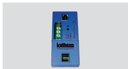
Il modulo basato su processore va collegato alla centralina elettronica Secop.
