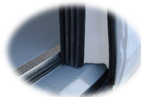
5 portées de joint de portes arrière
