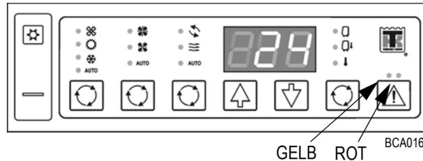
Erscheint eine **GELBE Warnleuchtanzeige**, arbeitet das System, aber die Warnung sollte so schnell wie möglich untersucht werden.
