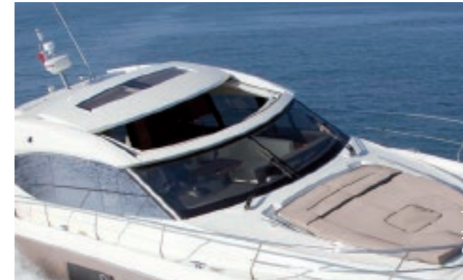
Dachkonstruktion für extra große Glas- und Verbundplatten
